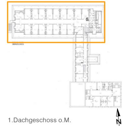
1: Grundrisse 1.DG, ca. M1:250, mit Tragsystem Decke über 1.DG: Die Decke über 1.DG ist wie die Decke über dem Ballsaal aufgebaut: Stahlträger in Gebäudelängsrichtung an StB-Rahmen angehängt, dazwischen Holzbalken in Querrichtung. Die Wände im 1.DG sind nichttragend.
