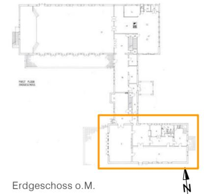
1: Grundriss EG, ca. M1:200, mit Tragsystem Decke über EG: Das Erdgeschoss ist ebenfalls massiv errichtet, vermutlich mit Ziegelwänden und Stahlbetonflachdecken. Die Binnenwände sind überwiegend tragend. Auf Grund rezenter Umbauten können Unterzüge vorhanden sein, diese wurden jedoch nicht genauer untersucht. Über dem ehem. Speisesaal ist ein Luftraum, d.h. keine Decke über EG vorhanden.
